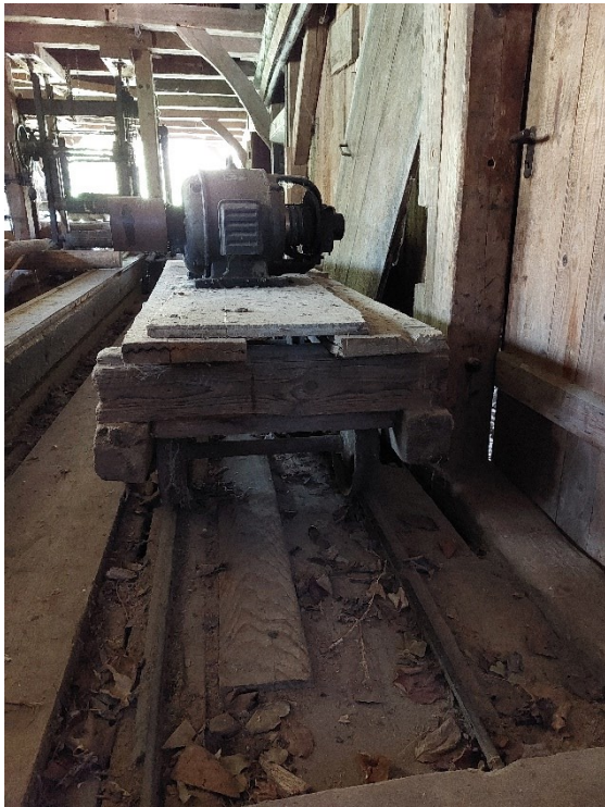
Abbildung 3: Sägeloze auf Gleis. Darauf steht der defekte, ausgebaute Elektromotor
