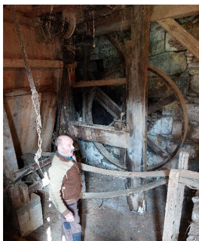
Abbildung 6: Das grosse Rad im Hintergrund ist noch die Transmission ab dem Mühlrad (Wasserantrieb).
