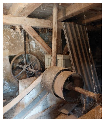
Abbildung 4: Wozu diese, quer durch den ganzen Raum laufende Welle? Sie könnte bereits vor der Elektrifizierung existiert haben.
